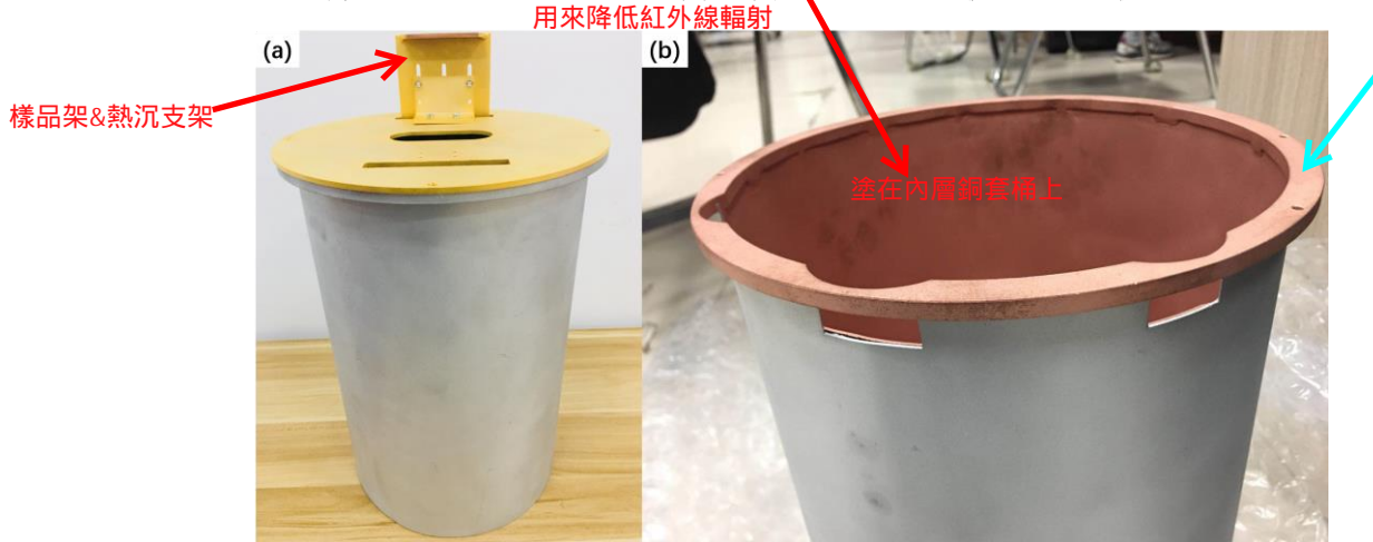
图 3.3.2 铜铝复合屏蔽桶结构。(a) 组合式复合结构，我们把样品热沉支架也一并组合在内；(b) 另一种铜铝夹心套筒，内层为铜制，外层额外包裹了一层铝皮。
